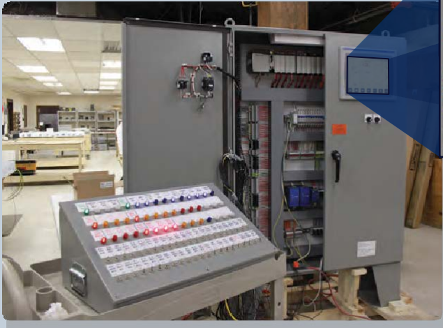
Экран ЧМИ для обзора системы управления горелкой транспортельного котла
