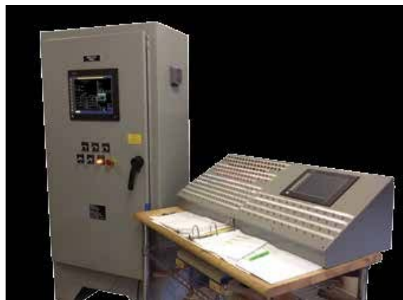
Заводские приемочные испытания заказчика системы управления горелкой и системы регулирования процесса горения
